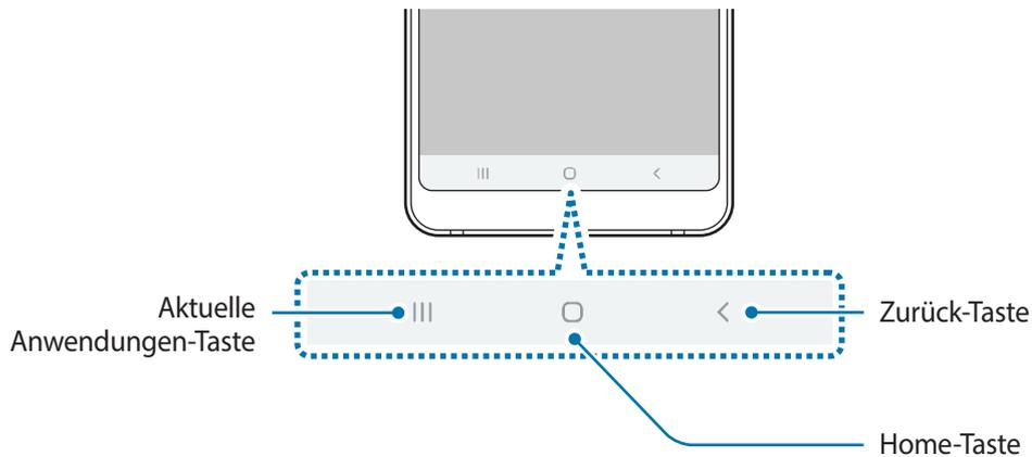
Wenn Sie das Display einschalten, werden unten auf dem Bildschirm die Softkeys angezeigt. Die Softkeys sind standardmäßig die Aktuelle Anwendungen-Taste, die Home-Taste und die Zurück-Taste. Weitere Informationen finden Sie unter [Navigationsleiste \(Softkeys\)](#).
